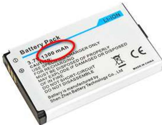
Exemple de batterie indiquant sa capacité.
